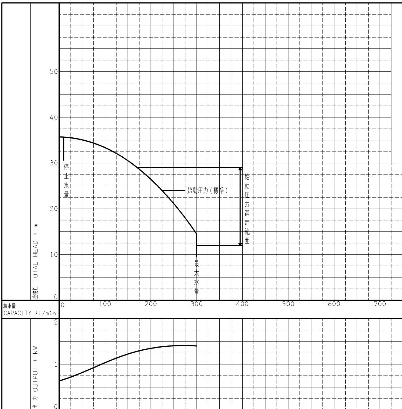
1. 始動圧力(標準)は工場出荷時の値です。変更する場合は始動圧力選定範囲内で設定してください。
