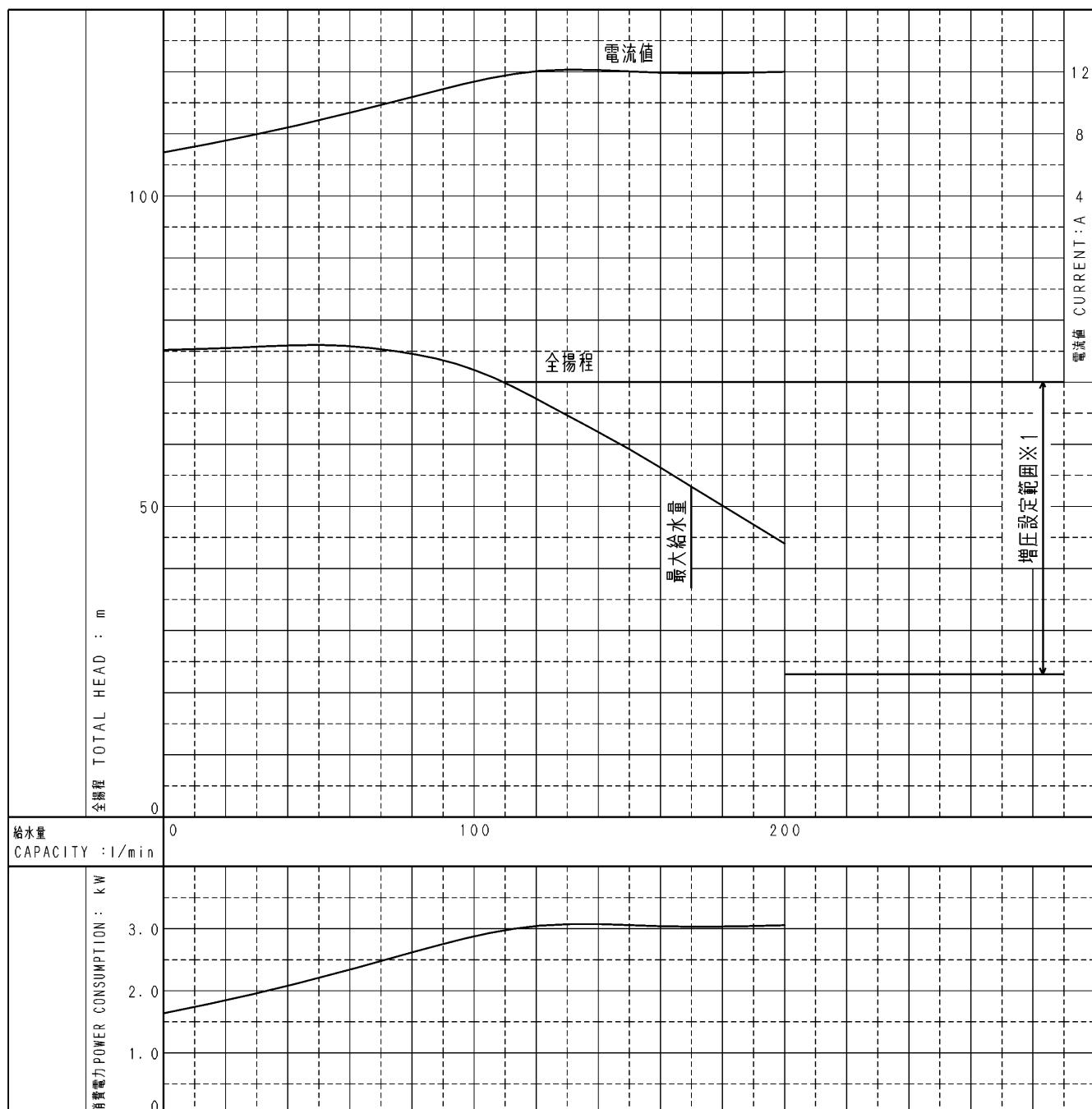
本性能曲線は最高回転速度におけるポンプ性能からユニット内損失を差し引いたもので示してあります。
